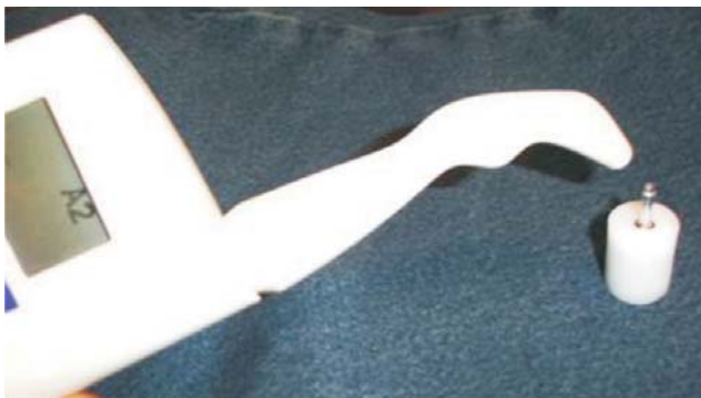
Figura 4: Medição por meio de frequência de ressonância realizada com Osstell™ e um transdutor.
