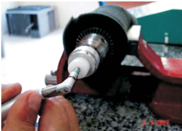
Figura 4: Medição por meio de frequência de ressonância realizada com Osstell™ e um transdutor.
