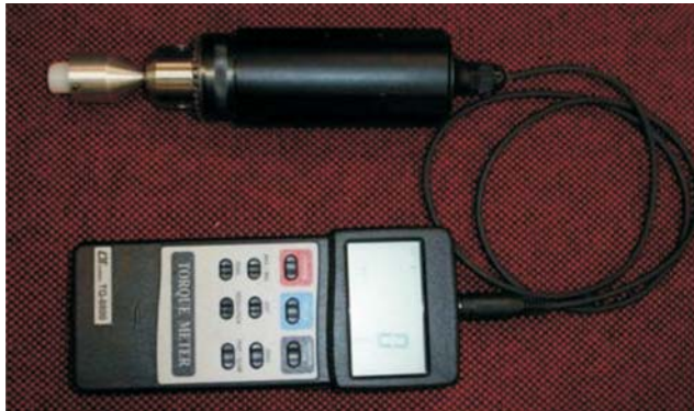
Figura 3: Implante sendo inserido no cilindro de polietileno fixado ao torquímetro digital
